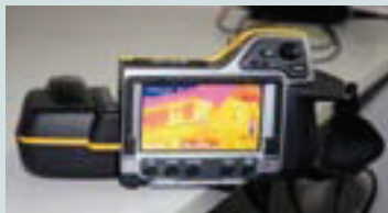
Abb. 1 Thermografie mit Hilfe einer Infrarotkamera © SAENA
