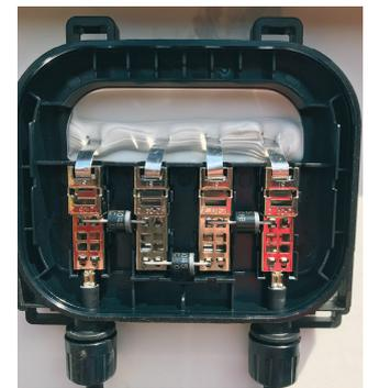
Abbildung 13: Aufbau einer Modul-Anschlussdose mit Bypass-Dioden
