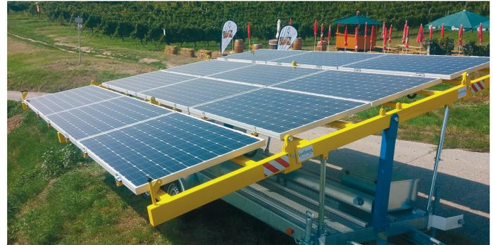
Abbildung 8: Mobiler Solargenerator als Anhänger für Events
