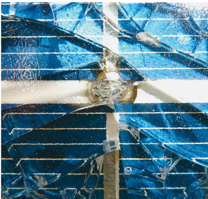
Abbildung 114: Blitzschaden an einem Solarmodul
