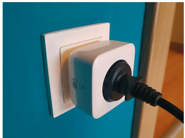
Abbildung 71: Fernsteuerbare Steckdose mit Messung des Stromverbrauchs
