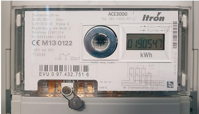
Abbildung 27: Digitaler Zweirichtungszähler
