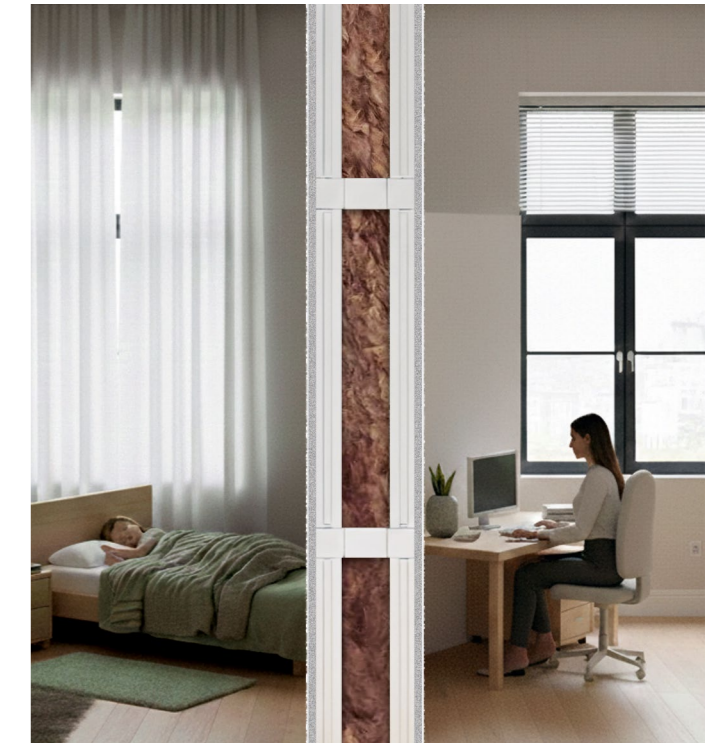
Schallsisolierung durch Mineralwolle (Prinzip – Trennwand in Ständerbauweise)
