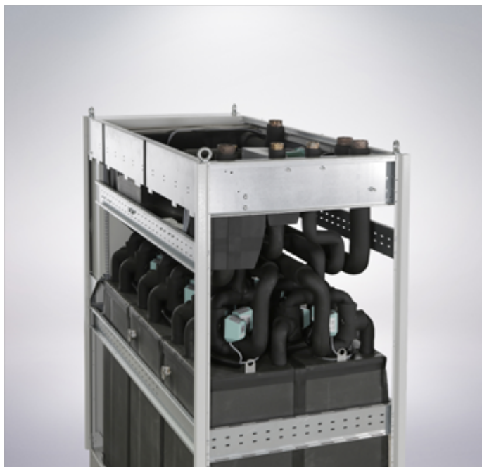
Adsorptionskältemaschine auf Silikagel-Basis, betrieben mit Heißwasser zwischen 50 und 90 °C, SorCool GmbH
