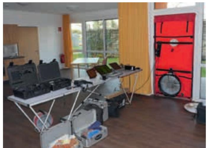
Abb. 9 Eingesetzte Vorrichtung im Türschwelle für die Messung der Luftdichtheit
