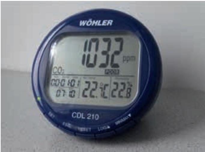
Abb. 2 Messgerät zur Überwachung der CO<sub>2</sub>-Konzentration, Raumluftfeuchte und Raumlufttemperatur
