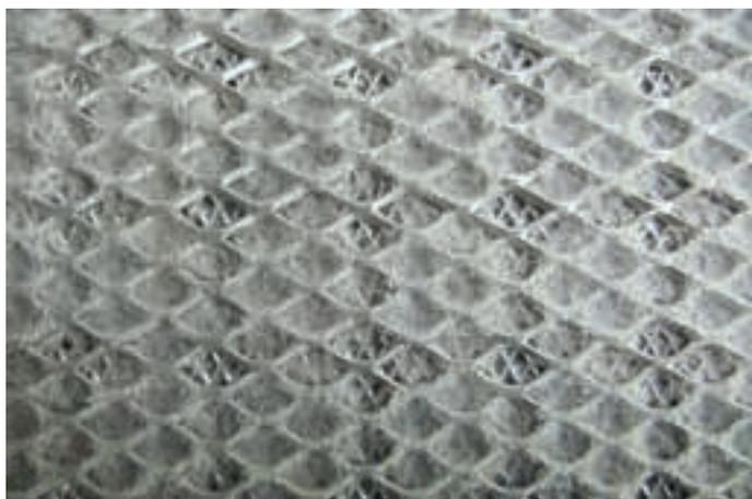
Abb. 76 Staubversetzter Abluftfilter nach 90 Tagen
