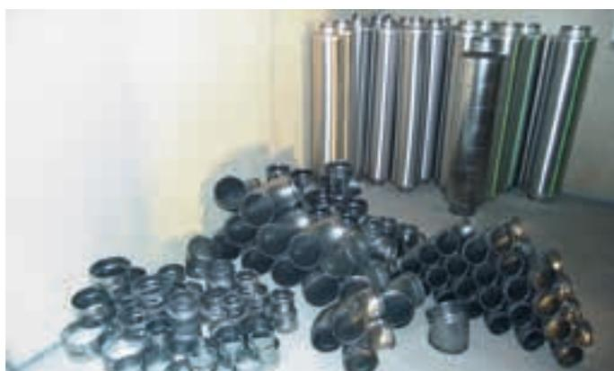
Abb. 74 Trockene und staubfreie Lagerung von Bauteilen eines Lüftungssystems
