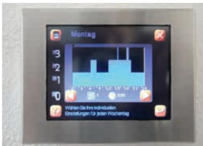
Abb. 45 Einstellung der Lüftungsstufen nach Zeit und Wochentag
