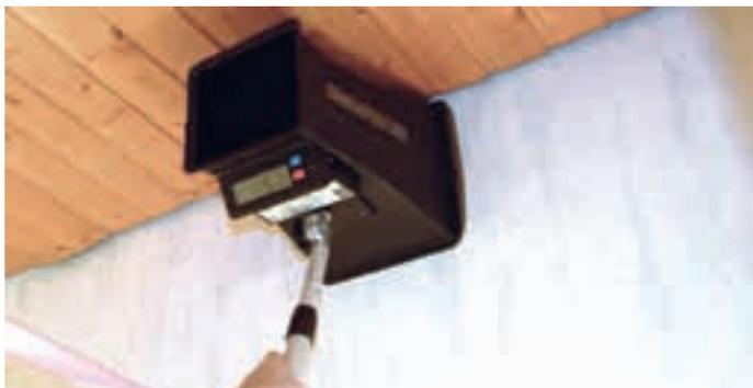
Abb. 75 Volumenstrommessung mit Anemometer
