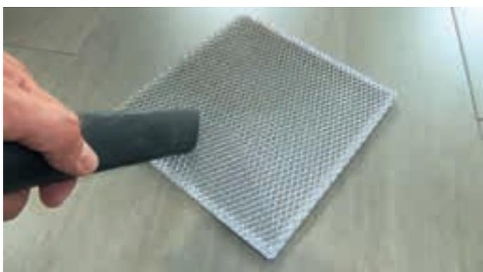
Abb. 78 Absaugen des Abluftfilters (Grundreinigung)
