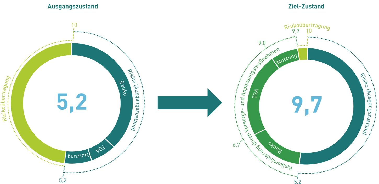
Abbildung 14: Bewertungsdiagramm des Sächsischen HWVA für ein Beispielgebäude. Durch die Umsetzung der Vorsorge- und Anpassungsmaßnahmen verringert sich die Schadensanfälligkeit des Gebäudes deutlich; die Bewertungszahl steigt von 5,2 (Ausgangszustand) auf 9,7 (Ziel-Zustand) von maximal erreichbaren 10 Punkten.
